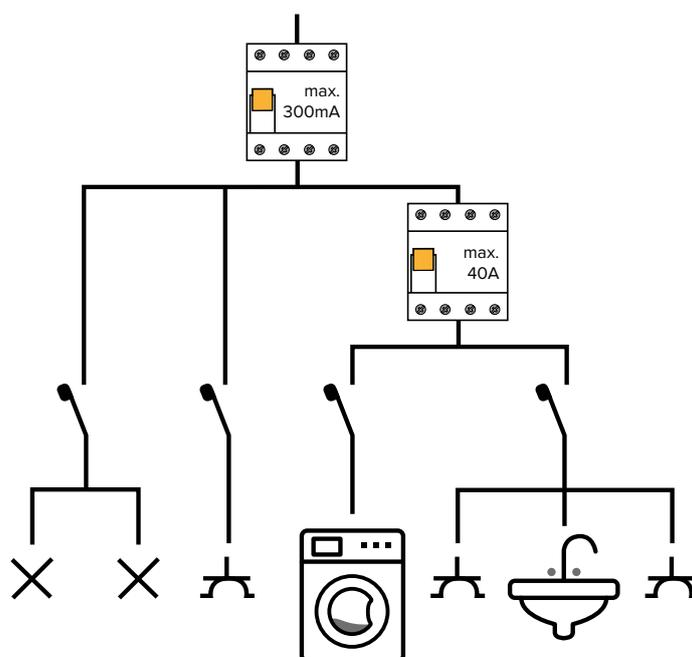
Un différentiel au moins doit être installé à l'origine de l'installation :
