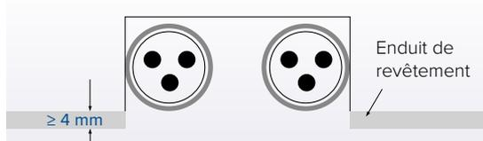
(\*) Dans du béton : 3 cm min.
