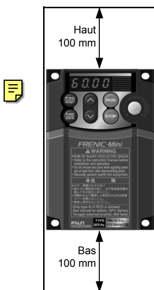
Figure 2-2-1 Sens de montage et distances nécessaires
