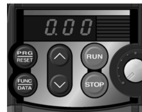
Figure 4-1-2 Afficheur LED après la mise sous tension
