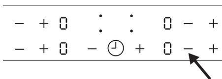
Appuyez simultanément sur les touches et d'une zone de cuisson pour la désactiver. Les réglages repasseront à .
