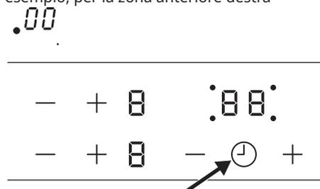
Sfiorare il **+** o il **-** del Timer per impostare il tempo tra **00** e **99** minuti. Quando il display della zona di cottura lampeggia più lentamente, viene effettuato il conto alla rovescia del tempo col Timer. Impostare il livello di potenza.
