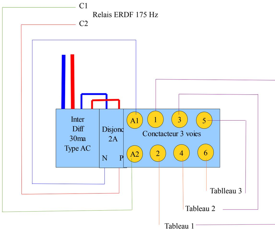
Voici le schéma de câblage à exécuter lorsqu'il n'y a qu'un seul abonnement EDF, et plusieurs tableaux secondaires à distribuer en Heures Creuses / Heures pleines.
