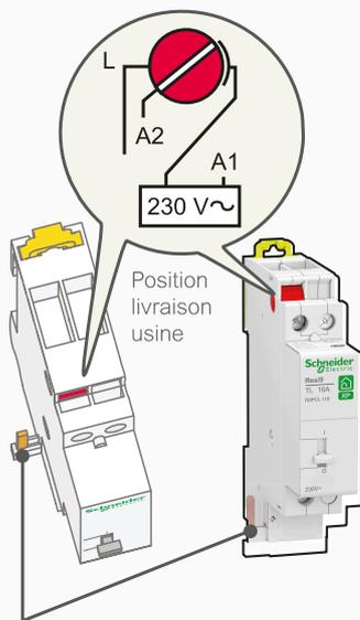
Le sélecteur en position A2 nécessite la suppression du peigne de raccordement
