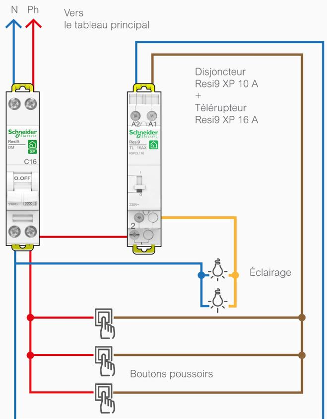
Section des conducteurs cuivre de 1,5 mm<sup>2</sup>
