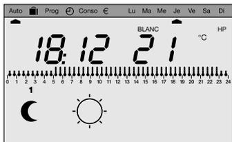
Dans l'exemple ci-dessus, la zone 1 est en réduit et la zone 2 est en confort.
