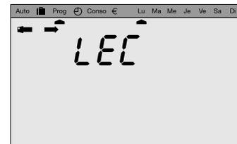
4. Appuyer sur **OK** pour confirmer (AUTO clignote). Les programmes contenus dans la clé sont enregistrés sur votre Pilotec confort.
