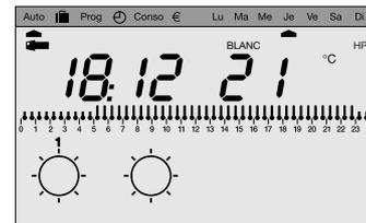
4. Appuyer sur la touche **OK**, le Pilotec confort passe en mode automatique et exécute les programmes contenus dans la clé.
