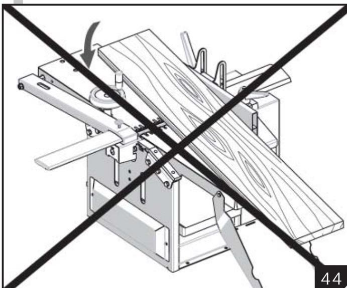
**Important :** La machine n'est pas prévue pour effectuer d'autres utilisations que de dégauchir ou raboter. Il est donc interdit de profiler, tenonner, mortaiser et de faire des feuillures.
