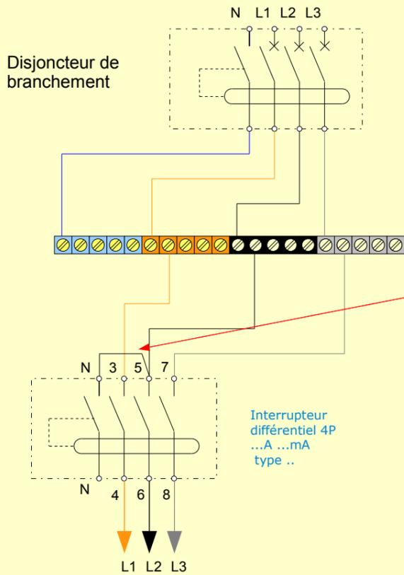
Relier la borne N à la borne 5 pour permettre la fonction test
