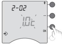
**Remarque :** avant de modifier la température, l'appareil doit être en service depuis au moins 2 heures.
