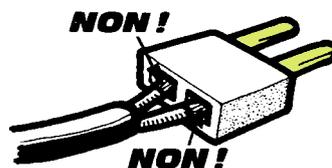
Quelqu'un a modifié un câble usagé ou détérioré en le raccourcissant, par exemple, après avoir coupé une extrémité usagée. Le raccord ainsi fait ne présente plus les garanties d'isolement qu'avait le câble neuf.
