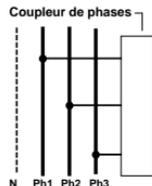
Dans le cas d'une installation en triphasé, vous devez utiliser un coupleur de phases (réf : 6051046) pour émettre sur les 3 phases simultanément.
