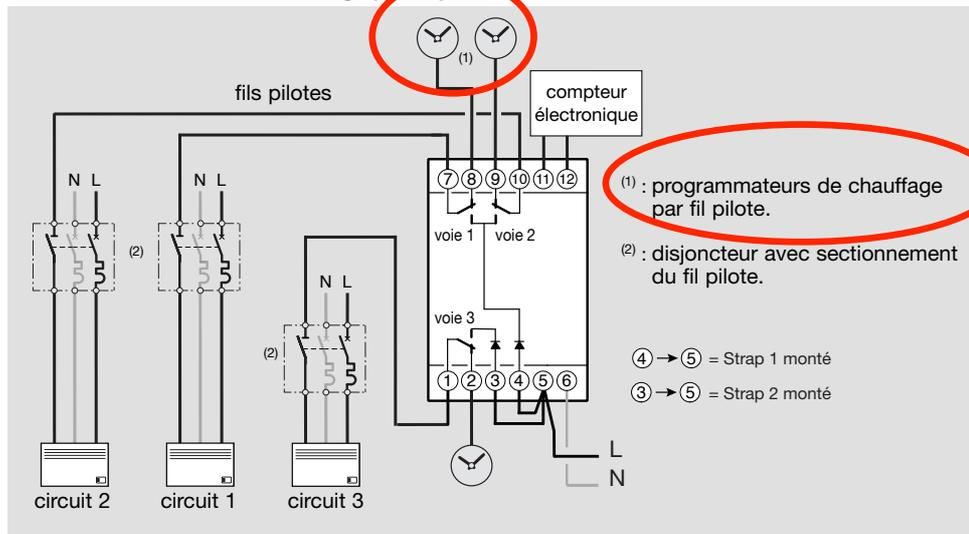
Les 3 sorties doivent être en mode fil pilote, c'est à dire straps 1 et 2 montés.
