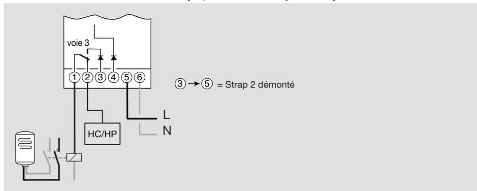
La sortie 3 doit être en mode contact, donc strap 2 démonté.
