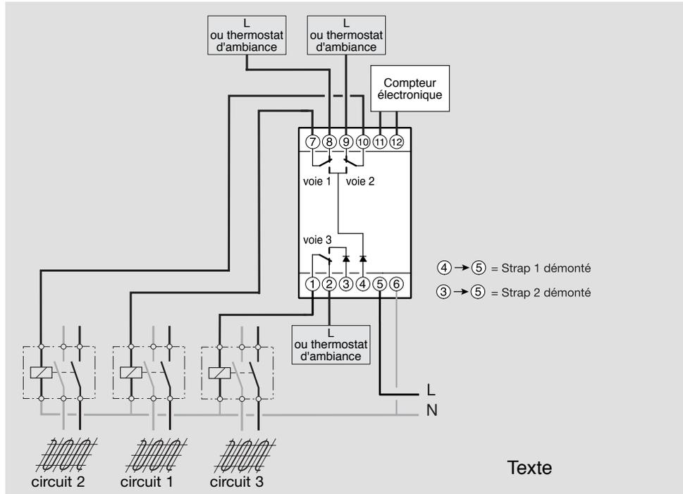
Les 3 sorties doivent être en mode contact, c'est à dire straps 1 et 2 démontés.
