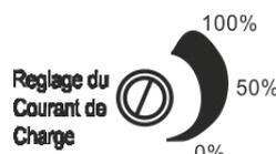
En plus de paramétrer le chargeur en fonction du type de batterie à recharger, il est possible, en fonction de votre utilisation, de régler le courant de charge en tournant la molette (**cf descriptif technique N°5**) dans le sens inverse des aiguilles d'une montre pour augmenter le courant et dans le sens contraire pour le diminuer. En cas de doute contacter votre installateur.
