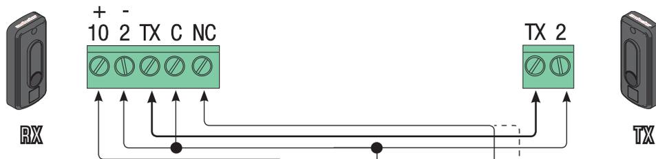
**C1** - Contact (N.C.) de « réouverture durant la fermeture »
